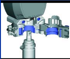
3 Stift herausziehen. Unterpumpe ist frei.
